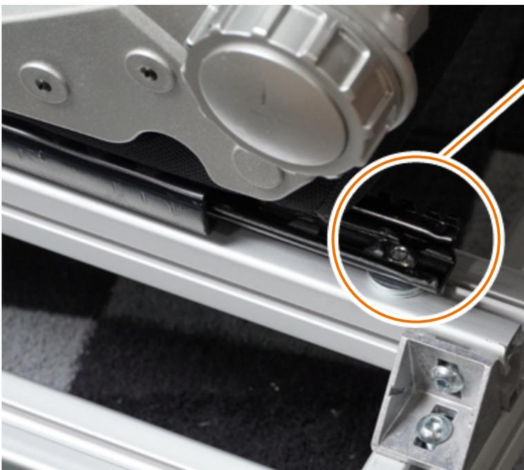
Montage mit Nutenstein und Schraube. Gegebenenfalls ist eine oder zwei Unterlegscheiben 24 (mitgeliefert) nötig, falls die Schraube zu lang ist.
